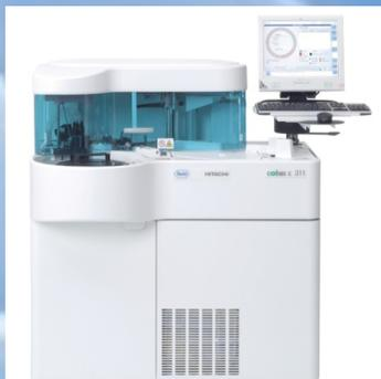
El área de química clínica es una de las más importantes en el laboratorio. Para ésta sección se cuenta con un auto-analizador Cobas c311 de Roche que dispone de un amplio menú de reactivos, con 42 posiciones refrigeradas para la colocación de los mismos, que se presentan en forma de cassette líquidos y listos para usar, lo que minimiza el riesgo de contaminación y manipulación. Cuenta además con una sonda multifuncional para punzar los cassettes sellados de los reactivos,
